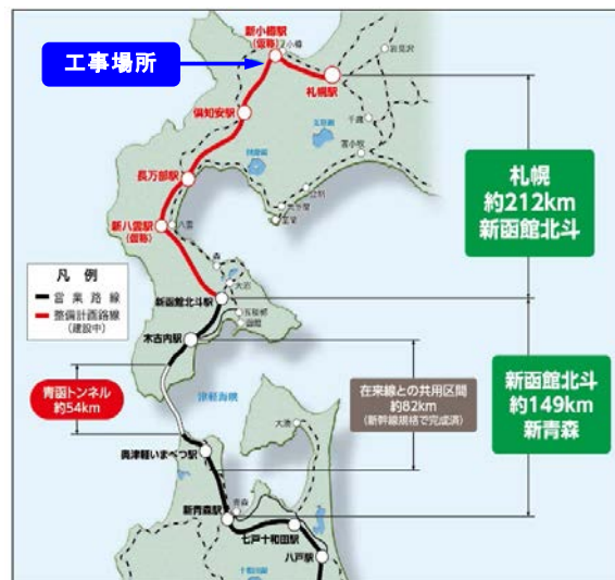
工事名：北海道新幹線、後志トンネル（天神）他 発注者：独立行政法人鉄道建設・運輸施設整備支援機構 北海道新幹線建設局 施工者：安藤ハザマ・伊藤・堀口・泰進北海道新幹線、 後志トンネル（天神）他特定建設工事共同企業体 工期：2019年11月1日～2025年6月30日 トンネル施工延長：4,460m 幅員：約10m 高さ：約8m
