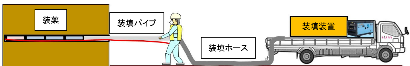
図-2 遠隔爆薬装填装置の使用イメージ
