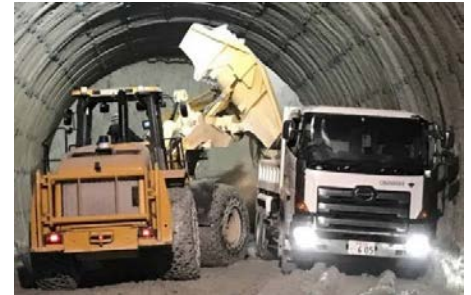
図2. サイドダンプ式ホイールローダ
