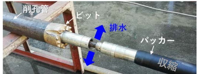
図-4 パッカー収縮状況
