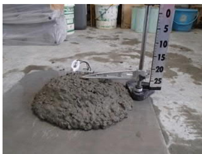
写真-4 中流動コンクリート
