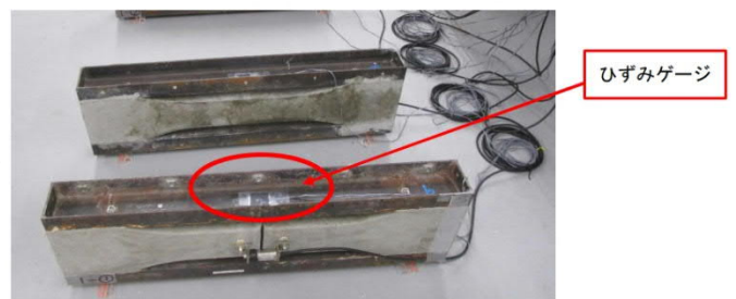
写真-1 ひずみゲージ取付状況
