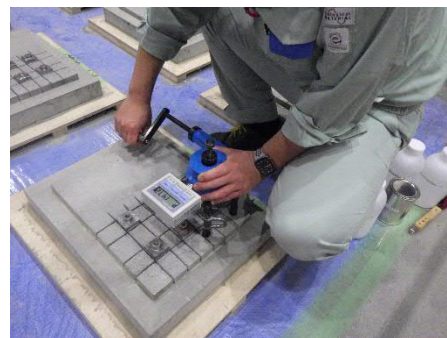
写真-2 建築研究所方式の引張試験の状況
