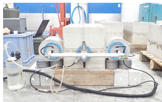
写真-1 透水試験の実施状況
