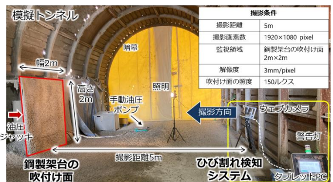
図3 模擬トンネル内の機器の配置
