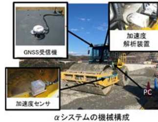
図-4 αシステムの機械構成
