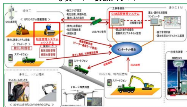
図-2 安威川ダムに適用されているダム情報化施工技術
