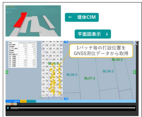
図-4 コンクリート品質管理システム
