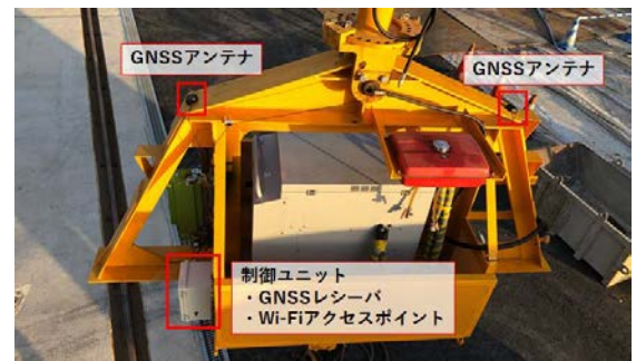
写真-2 フックブロックへの設置状況
