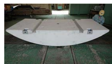
写真-2 脱型後の外観
