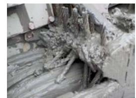
写真-1 水平回転式掘削機 写真-2 ドラムカッター 写真-3 ドラムカッターの粘着状況 写真-4 従来の粘着対策（ワイヤーブラシ）
