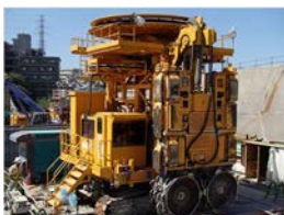
写真-1 水平回転式掘削機 写真-2 ドラムカッター 写真-3 ドラムカッターの粘着状況 写真-4 従来の粘着対策（ワイヤーブラシ）
