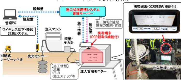
図-3 施工状況連携技術
