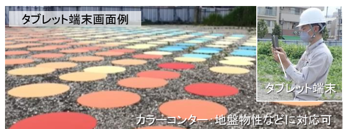
図-3 地盤物性のAR可視化
