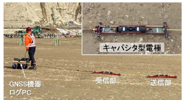
写真-1 キャパシタ型電極とCSG打設面における比抵抗計測状況
