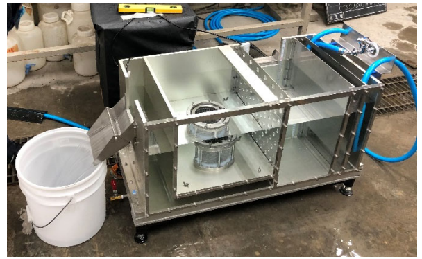
写真2 透水試験水槽(透水試験状況)
