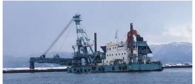
写真-1 カルシア落下混合船（函館港）
