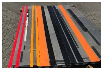
写真-9 テープの暴露試験
