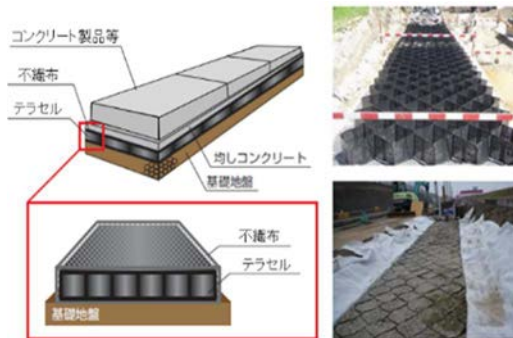
図4 テラセルマットレス工法
