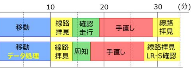
図-2 小型軌道検測装置データ活用による時間推移
