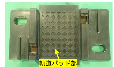
(b) ゴムカバーTP (タイププレート上面)
