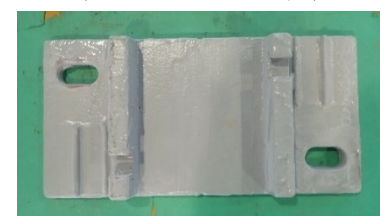
(c) 絶縁塗装TP (タイププレート上面)
