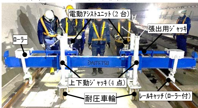
図-5 軌間拡幅台車の概要
