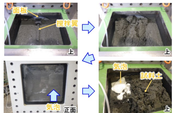
写真-3 気泡混合掘削土攪拌実験
