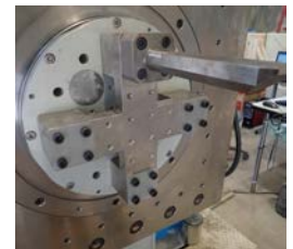
(a) ビットひずみセンサ (b) 面板取付状況 写真-2 ビットひずみセンサの取付状況
