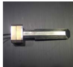
(a) ビットひずみセンサ (b) 面板取付状況 写真-2 ビットひずみセンサの取付状況
