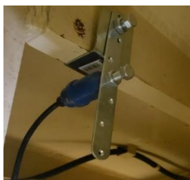
写真-3 地震計 (シールドマシン内面)
