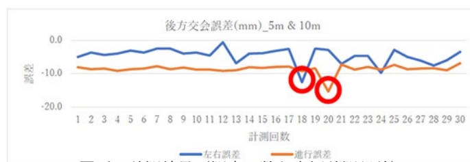
図-4 計測結果（測定回数と座標計測誤差）
