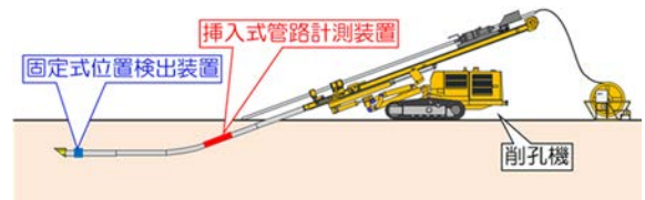
図-1 曲がり削孔位置検出システム
