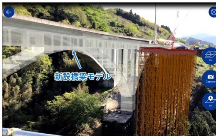
図-1 橋梁完成形モデル
