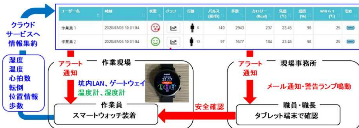
図4 ウェアラブルデバイスを用いた作業員の体調管理
