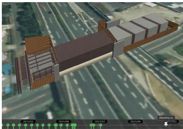
図-6 クラウドによる4Dモデルの共有(下端のバーで表示する時間を設定)
