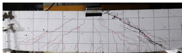
図4 試験体の破壊状況 (CASE2)
