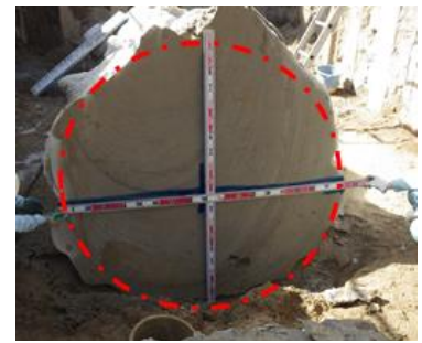
図-5 改良体切断面 (φ1.8m)
