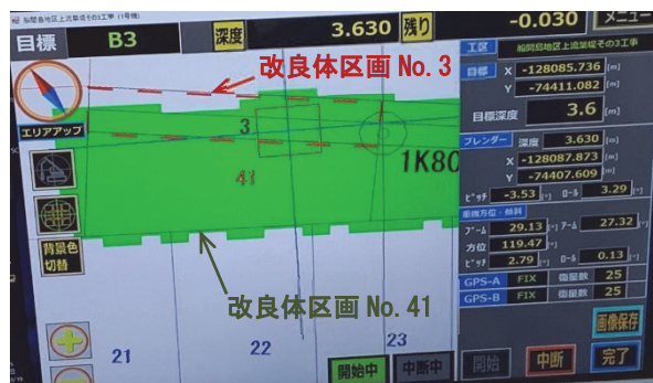
写真2 ICT平面管理（区画No.3施工中）
