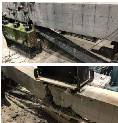
図-4 供試体の破壊状況 (上: EB-100 剥離 下: NSM-100 かぶり破壊)
