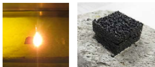
図3 PBFのレーザー照射状況と積層造形物
