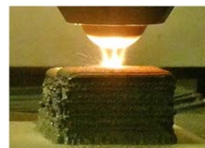
図4 DEDによる積層造形状況
