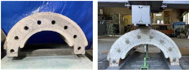
写真-9 内部充填状況 写真-10 載荷試験の状況
