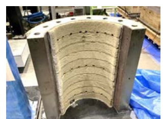
写真-8 流込み完了
