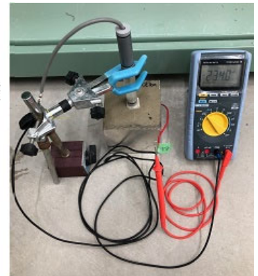
写真2 自然電位測定状況
