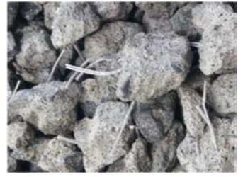
写真4 No.4の再生粗骨材
