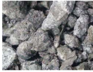
写真3 No.2の再生粗骨材
