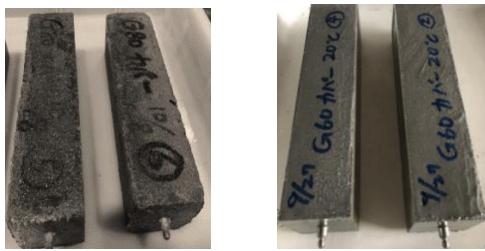
(a) 酸処理なし (b) 酸処理あり 写真-1 供試体表面のゲル状物質比較
