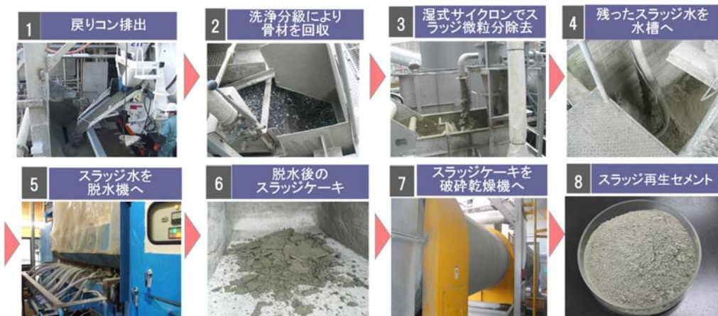
図-1 低炭素スラッジ再生セメントの製造工程
