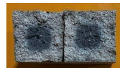
写真-3 500°C加熱後のFA100Cの供試体断面
