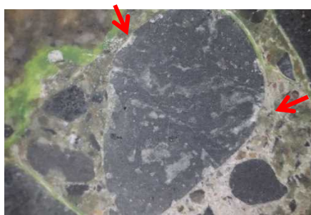
(a) 流紋岩(砂利)からのゲル滲み出し (b) 鉄筋腐食と腐食生成物
