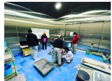
写真-2 コンクリート製造状況 (室温10°C)
