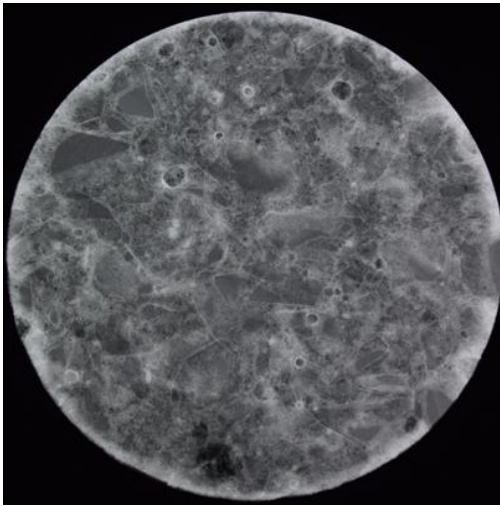
写真-1 縦方向から採取したコアのX線透過画像
