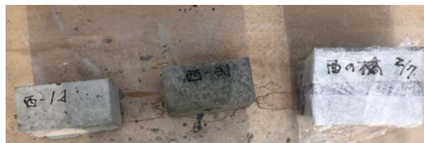
(b) 材齢 3 日経過時 写真 1 試験体養生状況
