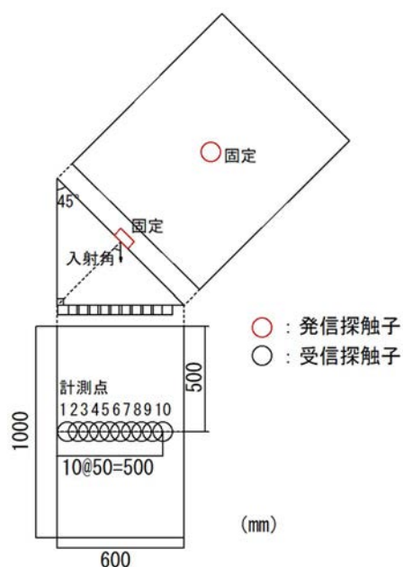
図-4 指向性に関する計測方法の概略図
