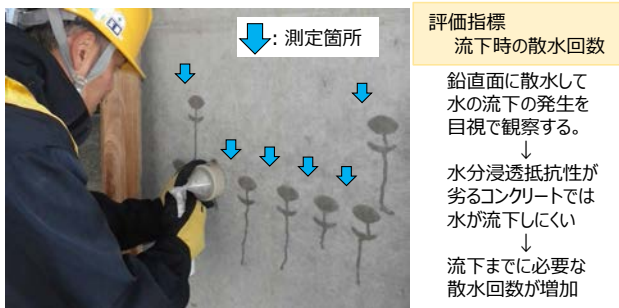
図1 鉛直面に適用される従来の散水試験の概要
