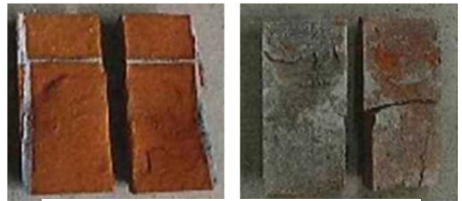
図-2 引張試験終了後の供試体の様子 左) P4-1 右) P4-4
