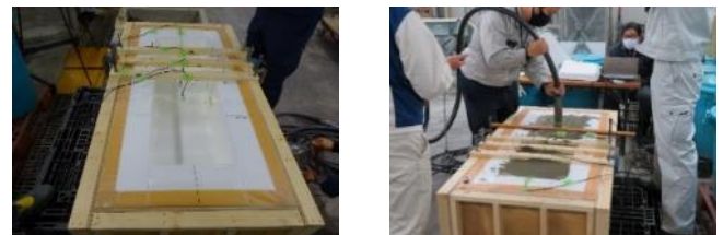
写真-1 左：加速度計取付位置，右：試験状況
